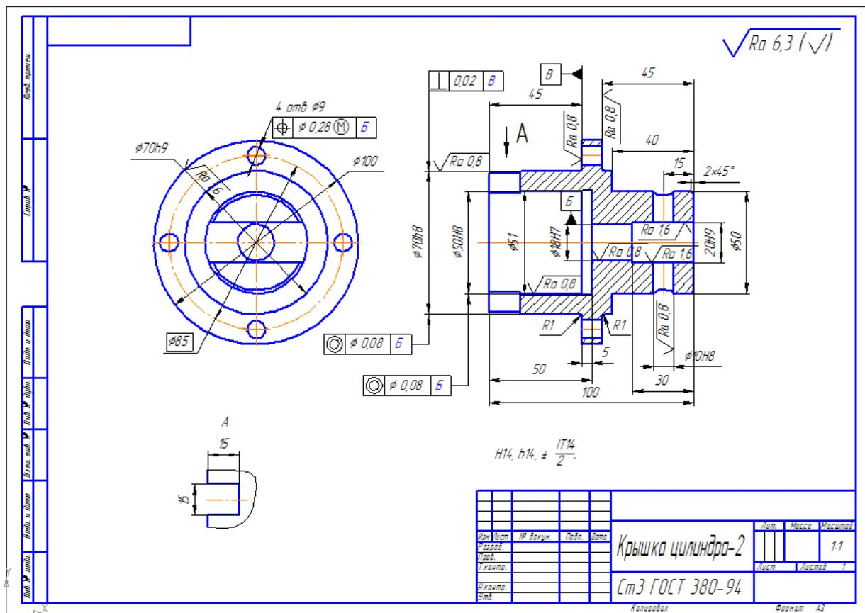
**Вопрос 1.** По чертежу детали сформулируйте основные требования по точности размеров, формы, взаимного расположения поверхностей и качества поверхностного слоя.
